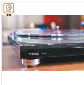
底座由人造雲石及MDF板兩層構成，堅硬度及穩定性比單一物料更高。
